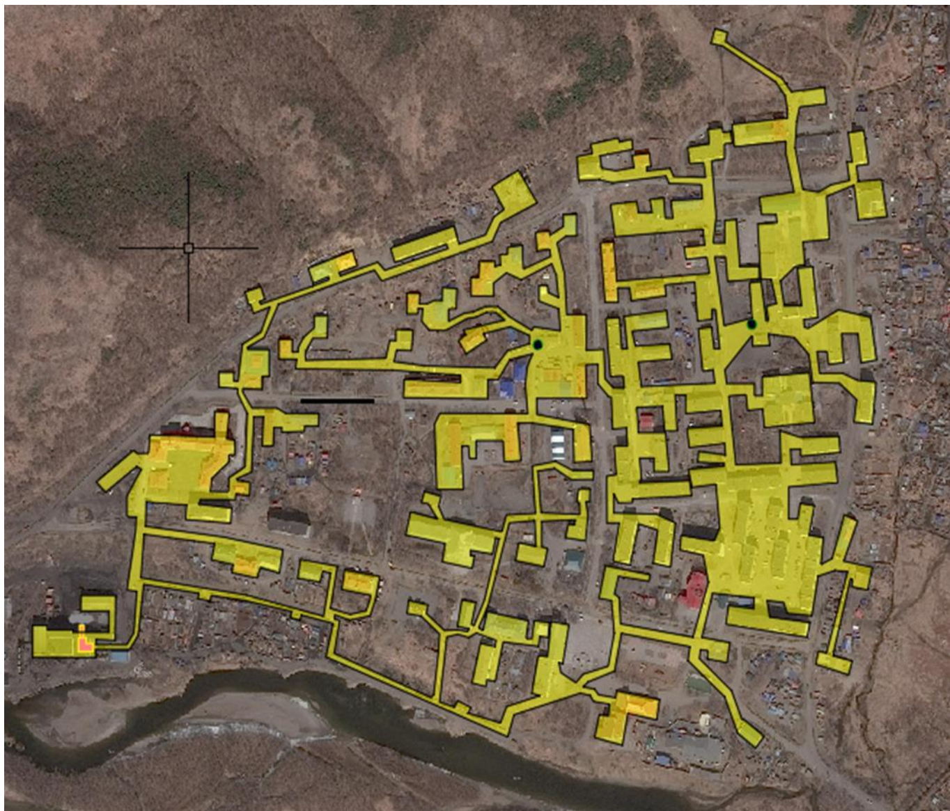
Рис. 1.1 – Зона действия котельной «Центральная» – пгт Палана
